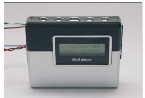
Bild 6: Mit etwas Geschick lassen sich die Verbindungsdrähte so aus dem MP3-Player herausführen, dass er nicht mit in das Gehäuse der Steuerung eingebaut werden muss.
