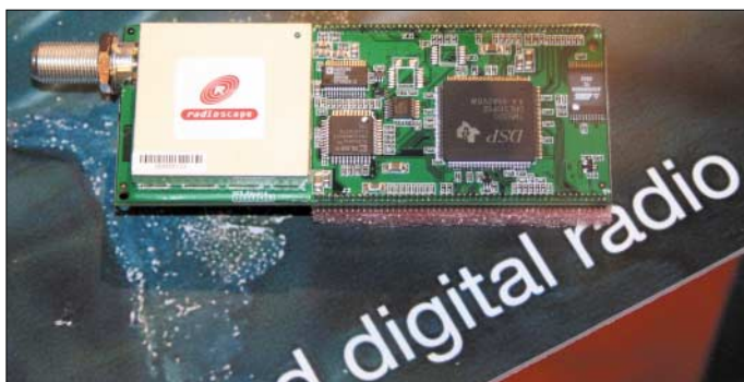
Bild 3: Dieses Kombimodul empfängt und demoduliert DRM, DAB, AM und FM und war auf der IFA 2005 zu sehen. Die für Weihnachten 2005 versprochenen DRM-Kofferradios lassen allerdings weiter auf sich warten.
