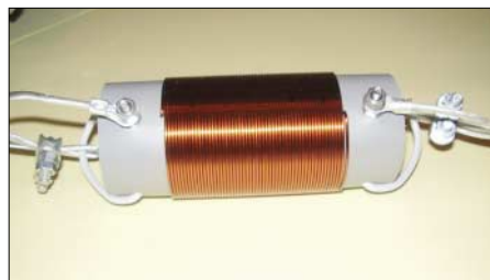
Bild 16: Ansicht einer Verlängerungsspule mit Plaströhr als Wickelkörper Foto: OE5CWL
