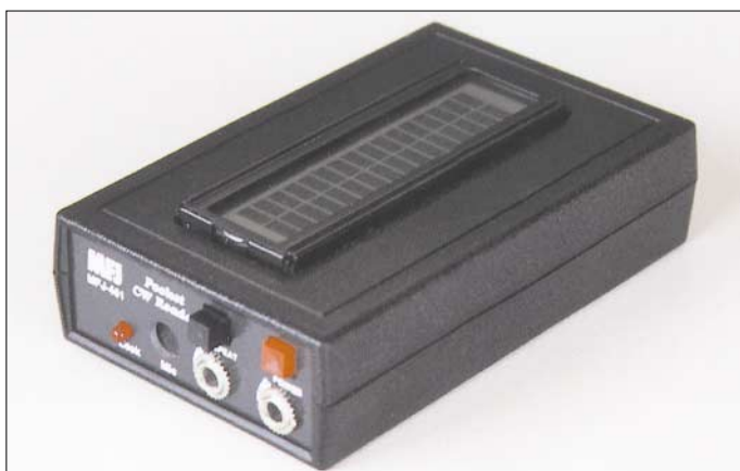
Bild 1: Der „Pocket Reader MFJ-461“ ist nur knapp so groß wie eine Zigarettenschachtel. Auf der flachen Oberseite befindet sich das Display zum Mitlesen der dekodierten Telegrafiezeichen. Die linke Stirnseite enthält alle Schalter und Buchsen.
