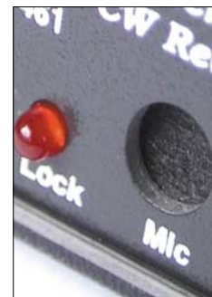
Bild 3: Die Detailaufnahme zeigt das Bohrloch im Gehäuse, hinter dem sich das eingebaute Mikrofon befindet.
