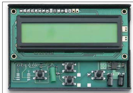
Bild 2: Unter dem LC-Display befinden sich Controller, EEPROM und PC-Schnittstelle.
