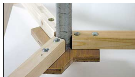
Bild 5: Die untere Trägerplatte des Stativs dient als Auflage für den Mast.
