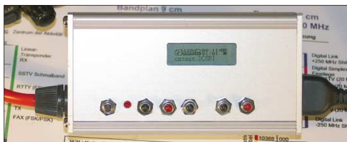
Bild 1: Das Display des MP3-Players ist durch eine Gehäuseöffnung auch nach dem Einbau sichtbar.
